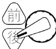
(4)変速ダイヤルを「低速」側へ回してください。
