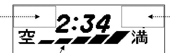
バッテリ残量メータ (バッテリの残量をバーの数で示します)
