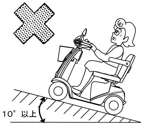
転倒する恐れがあるので、右図のような傾斜面（5°以上）でのご使用は、避けてください。
