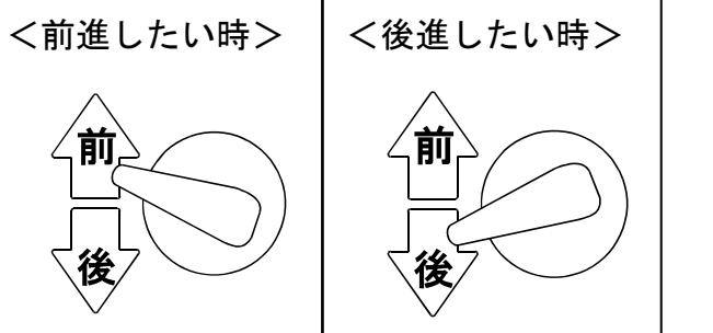
**重要** 前後進切替スイッチのツマミが操作パネル面から浮き上がっていると、上記前進位置を越えてしまう事があり、その場合は動きません。ツマミを取り外した場合は、操作パネル面との隙間が無い様に必ず元の状態に戻してください。
