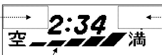
バッテリ残量メータ (バッテリの残量をバーの数で示します)
