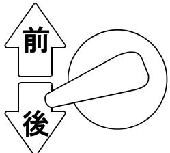
(4) 変速ダイヤルを回して最高速度を調節してください。
